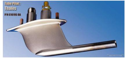
Le tube Pitot est placé dans le sens du flux à mesurer. L'ouverture, un orifice de quelques millimètres est orientée vers l'amont. La mesure de  $h$  (différence de hauteur d'un fluide incompressible de masse volumique  $\rho_l$  placé dans le tube en  $U$ ) permet la mesure de la vitesse  $V_0$  de l'avion. On note  $\rho$  la masse volumique de l'air autour du tube.
